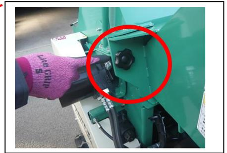
エンジンを停止し、ホッパー固定ネジを外して、ホッパーを開けてください。
