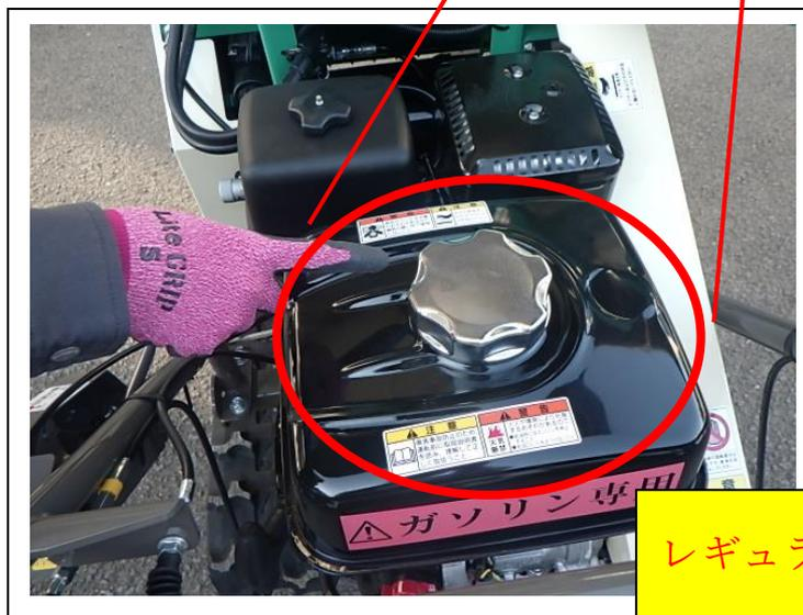
給油後は、ホッパーを元の位置に戻して、固定ネジを締めてください。
