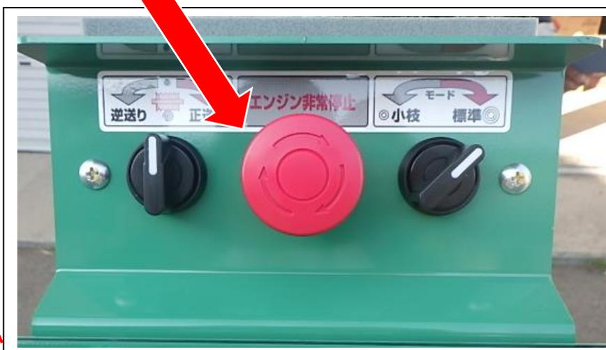
⑥粉碎作業が終わったら、送りスイッチを「停止」、スロットルレバーを「低」の位置に戻してください。
